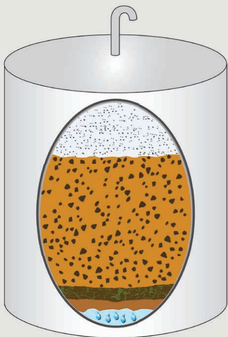
Tanque de armazenagem típico contaminado por sujeira, água e microorganismos.
